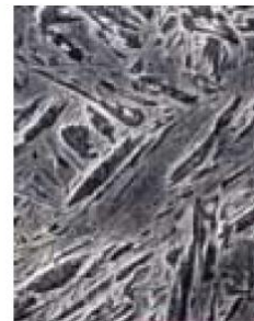
Микроструктура стали 500 HB, закаленной в воде
